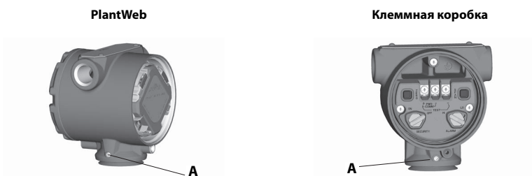
А. Стопорный винт поворота корпуса ( \frac{3}{32} дюйма)
