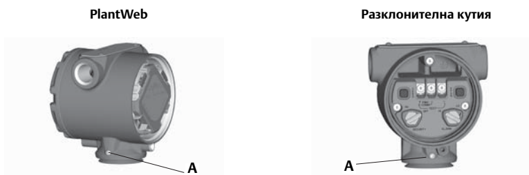
A. Стопорен винт за въртене на корпуса ( \frac{3}{32} инча)
