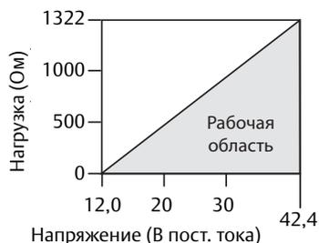
Для обеспечения связи полевому коммутатору требуется сопротивление контура 250 Ом.
