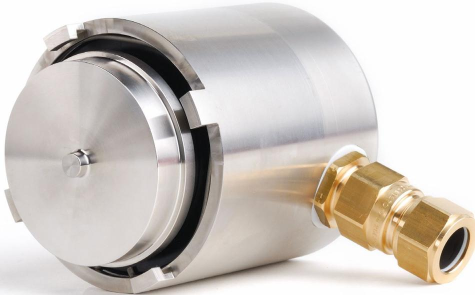
Устройство обнаружения песка SAM представляет собой систему неинтрузивного мониторинга, которая в реальном времени определяет вынос песка в линиях подачи воды, нефти, газа или многофазных линиях для береговых и морских месторождений. SAM предлагает операторам экономически эффективный инструмент для оптимизации производства, позволяя определять максимальные дебиты без песка или максимальную приемлемую его долю.
