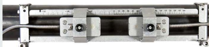
Измерение датчиками, смонтированными на портативном Variofix VP
