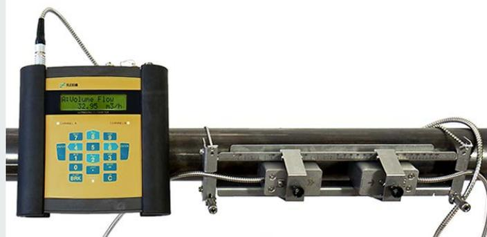
Измерение преобразователем расхода, установленным креплением QuickFix
