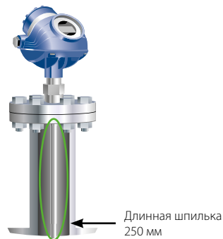
Рисунок 6.7.3: Одинарный гибкий зонд с длинным стержнем
