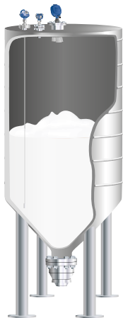
Рисунок 5.2.2: Зернохранилище с волноводным и бесконтактным радарным уровнемером
