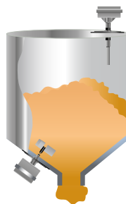
Рисунок 5.3.1: Контроль уровня с помощью лопастного и стержневого вибрационного сигнализаторов
