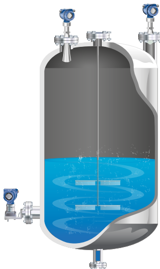
Рисунок 4.8.1: Измерение уровня в баке с мешалкой
