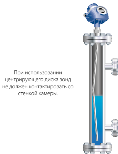
Рисунок 6.13.1: Не допускайте контакта зонда со стенкой выносной камеры
