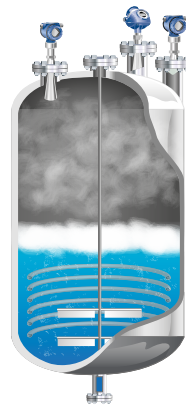
Рисунок 2.2.1 Бесконтактные радары с антеннами различных типов для применения в различных условиях.
