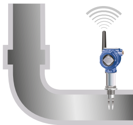
Рисунок 4.19.5: Беспроводной датчик для определения наличия жидкости в трубе
