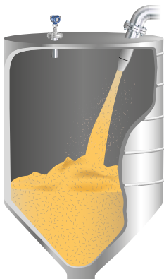
Рисунок 5.2.4: Бесконтактный радарный уровнемер на зернохранилище
