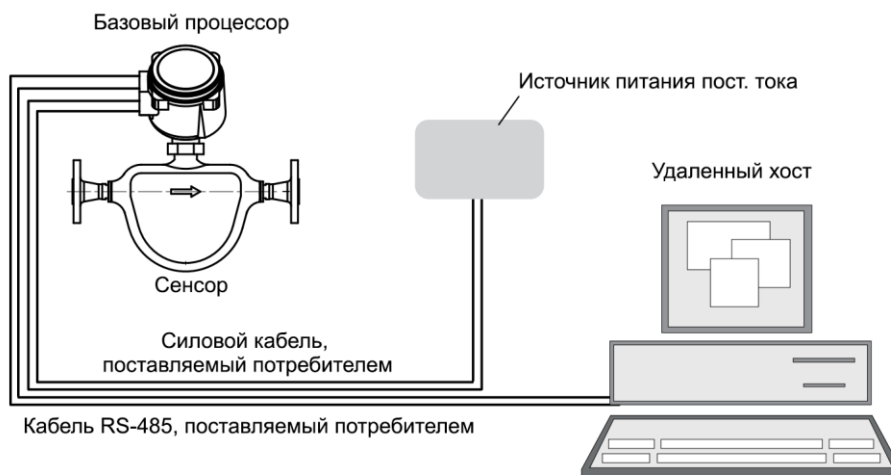
рис. 2 - 1. Упрощенная схема установки расходомера MVD Direct Connect — встроенный базовый процессор, без барьера искрозащиты
