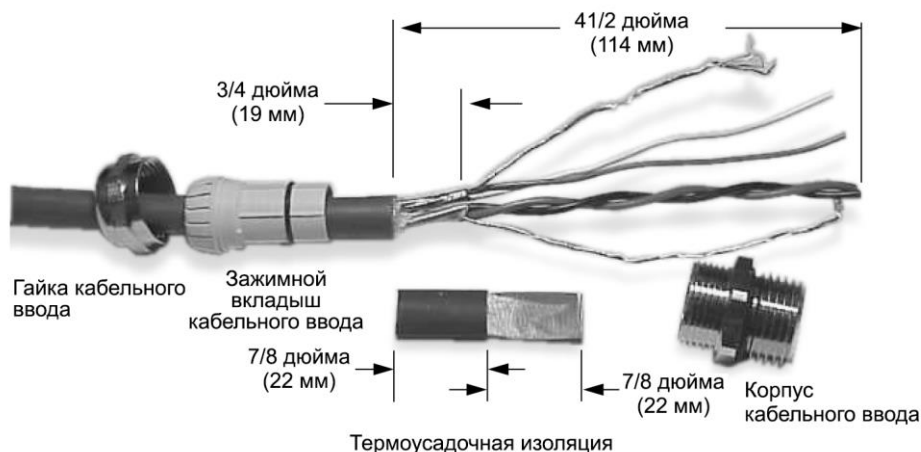
рис. 3 - 5. Кабельный ввод Micro Motion и термоусадочная трубка
