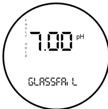
Рис. 8-8. Отображение неисправности, приводящей к отключению системы
