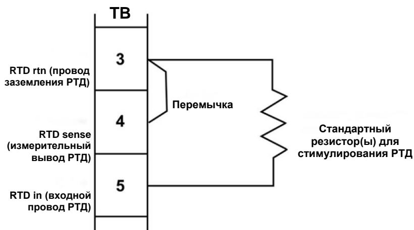
Рис. 8-4. Имитация температуры в анализаторе pH/ОВП 5081-Р
