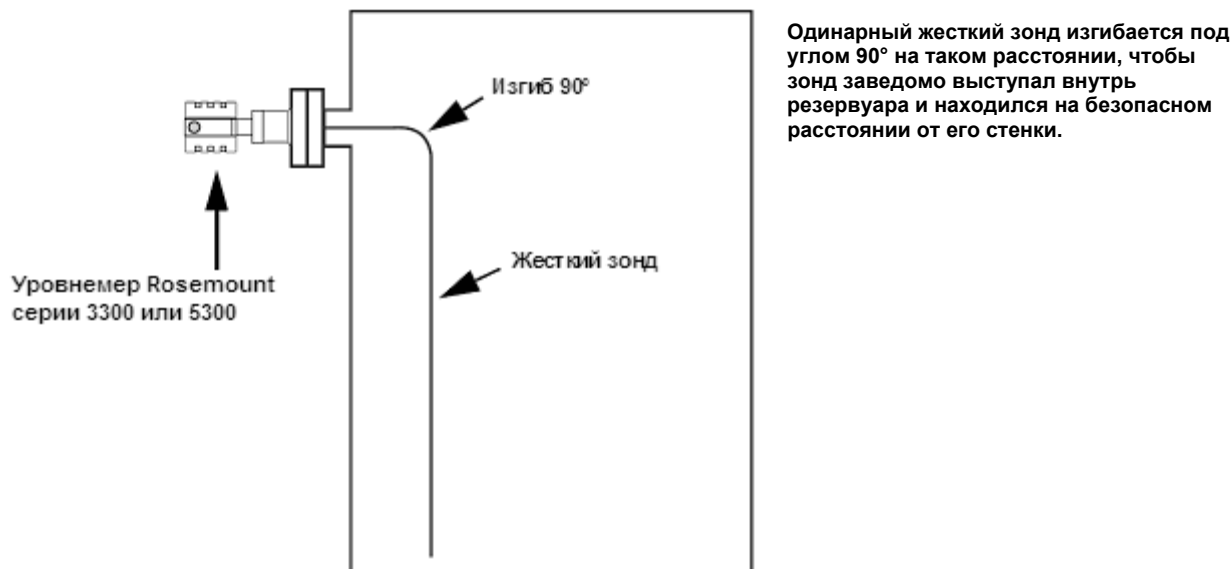
Рис. 2-10. Монтаж сбоку с использованием одинарного жесткого зонда.
