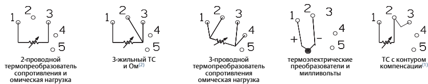
Рис. 2-15. Схема подключения для FOUNDATION Fieldbus
