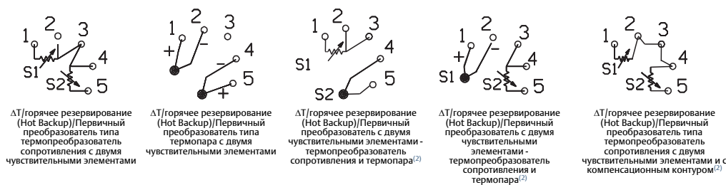
Рис. 2-15. Схема подключения для FOUNDATION Fieldbus
