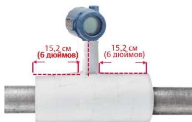
Рис. 2-8. Монтаж измерительного преобразователя 3144P с технологией Rosemount X-well
