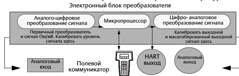
Рис. 3-13. Схема интеллектуального измерения температуры
