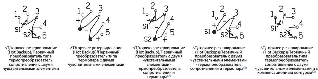
Рис. 2-12. Схема подключения первичных преобразователей HART / 4–20 мА
