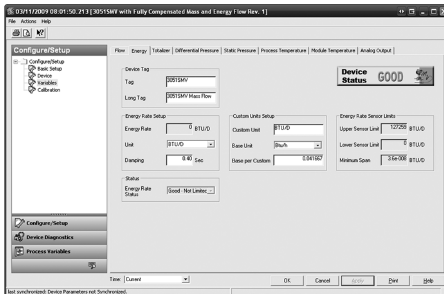
Рисунок 2-30. Пользовательские единицы измерения расхода энергии — пример пересчета времени
