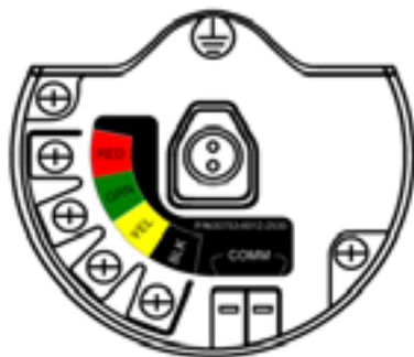
Рис. 5-5. Схема клеммного блока преобразователя для работы с датчиком обнаружения топлива
