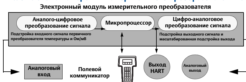
Рис. 5-4. Схема измерений измерительного преобразователя температуры
