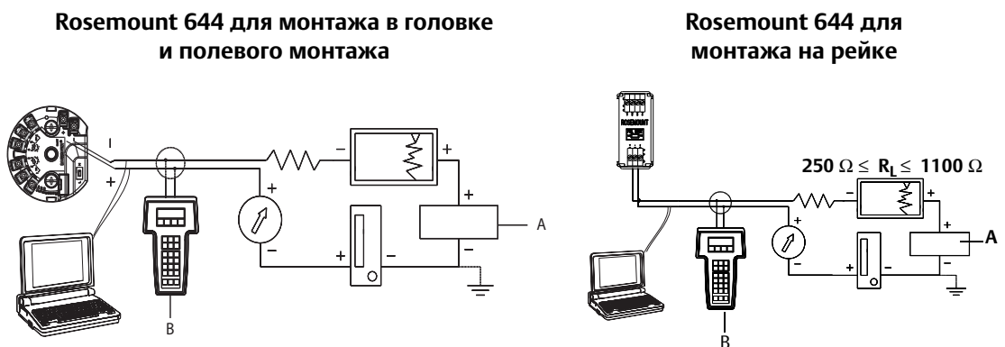
Рис. 2-1. Схема питания датчика при конфигурировании на стенде
