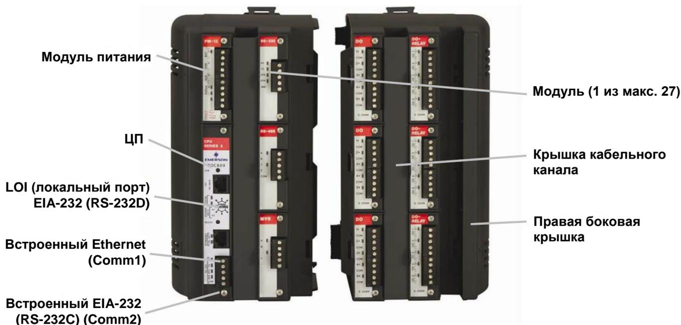
Рис. 1-2. Базовый блок ROC827 с одной расширительной объединительной панелью (для ясности показана отдельно)
