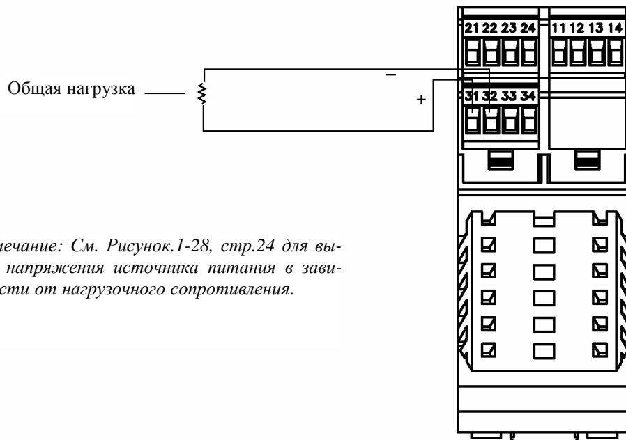
Рисунок 1-25. Подключение дискретного выхода 2-Клеммы 31 и 32 (Канал С)-Внутреннее питание
