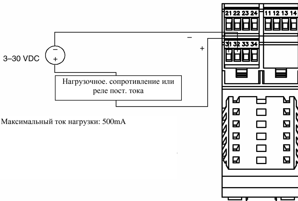
Рисунок 1-26. Подключение дискретного выхода 2-Клеммы 31 и 32 (Канал С)-Внешнее питание
