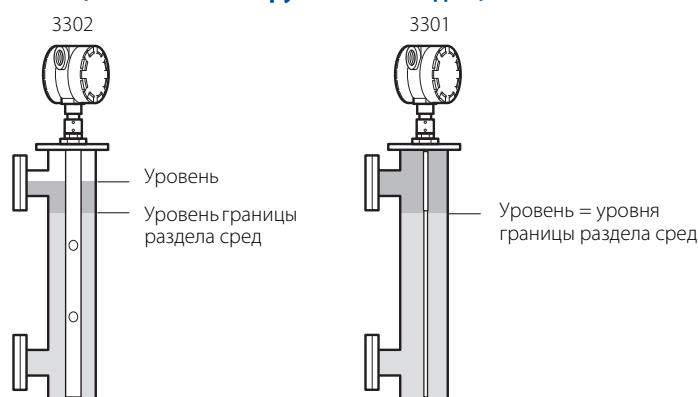
Рисунок 2-3. Измерение уровня границы раздела сред с помощью уровнемеров 3300 мод. 3302 и 3301 (с полностью погруженным зондом)
