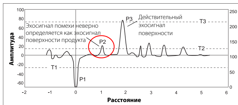
Рисунок 6-11. Пример 2: амплитудный порог T2 установлен слишком низко
