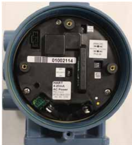
Рисунок 3-1. Электронная плата измерительного преобразователя полевого монтажа и аппаратные переключатели
