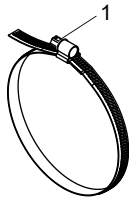
Рис. 6.25: Стальная лента с клеммным замком
