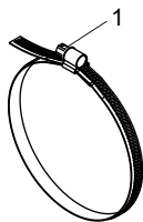
Рис. 6.44: Стальная лента с клеммным замком
