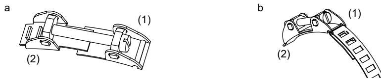
Рис. 6.70: Датчик температуры на трубе
