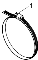
Рис. 6.50: Стальная лента с клеммным замком
