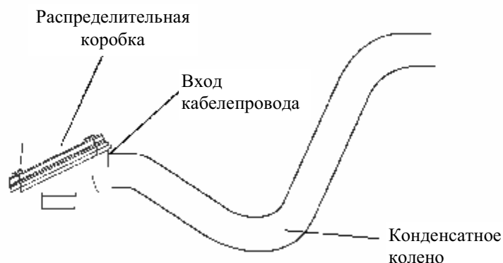
Рисунок 3-2. Конденсатное колено в кабелепроводе
