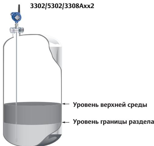
Достаточно редким, но возможным применением является измерение уровня границы между двумя жидкостями при полном погружении зонда. Показательным примером служит измерение уровня в установках для обессоливания и обратное измерение уровня границы раздела сред.
