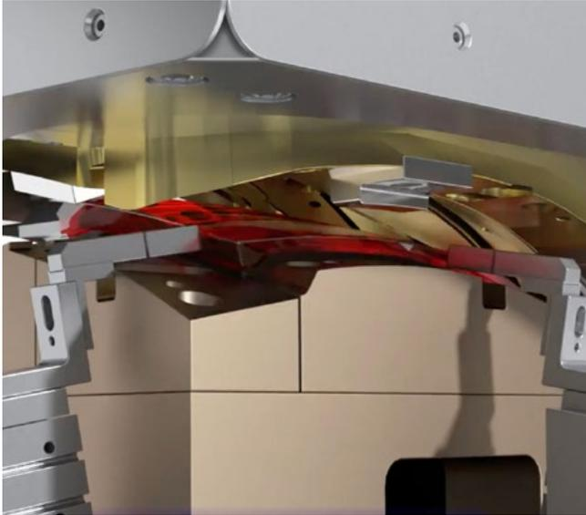
溶着時に部品が動かないため溶着の精度が高く、必要に応じて気密溶着が可能です。
