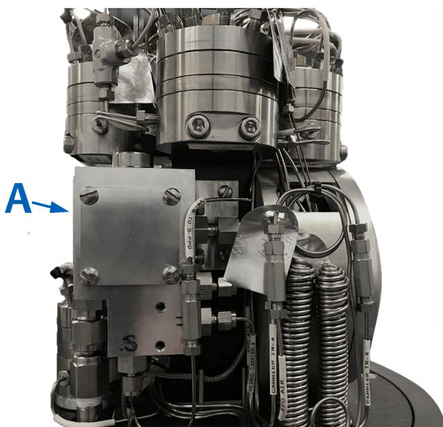
A.  $\mu$ FPD バーナー
