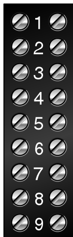
図 5-8: すべての D と DL、2005 年以前の F シリーズセンサ端子
