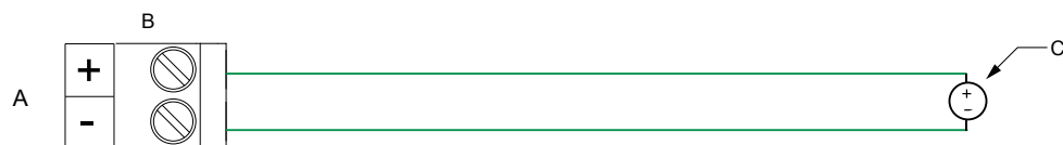
図 4-11: 外部電源の DI の配線
