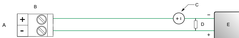
図 4-9: 外部電源の DO の配線
