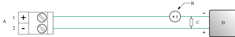
그림 3-8: mA/HART 출력 배선(외부 전원 공급)
