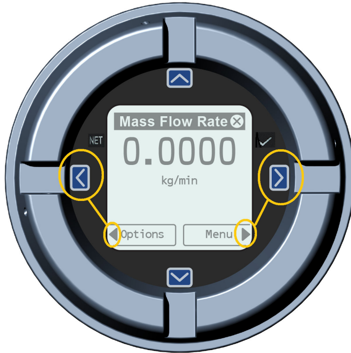
그림 6-2: 예 2: 트랜스미터 디스플레이에서 활성화된 화살표 표시
