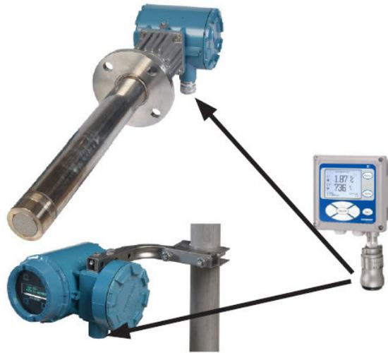
스마트 무선 THUM 어댑터는 Oxymitter 또는 Xi 전자장치의 표준 4~20mA 신호를 무선 신호로 변환합니다. 모든 HART® 정보는 프로세스 O<sub>2</sub> 값과 함께 전송됩니다. 안전 지역에서만 사용 가능합니다.
