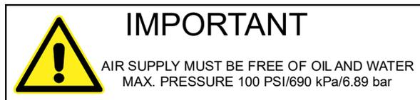
**Figure 1.3** Étiquette de sécurité située à l'arrière de l'actionneur Série 2000Xc
