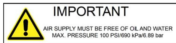
그림 1.3 2000Xc 시리즈 액츄에이터 후면에 표시된 안전 라벨
