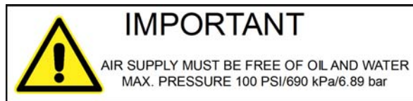
Рисунков 1.2 Предупреждающая табличка на приводе 2000Хс для заводской подачи воздуха
