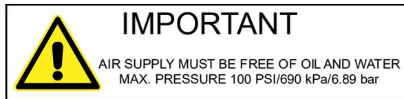
**Abbildung 1.3** Sicherheitsaufkleber an der Rückseite der Vorschubeinheit 2000Xc
