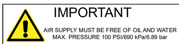
**Figura 1.3** Etichetta di sicurezza sul lato posteriore dell'attuatore 2000Xc
