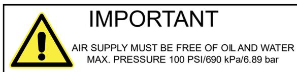
図 1.3 2000Xc アクチュエーターの背面に貼られている安全ラベル
