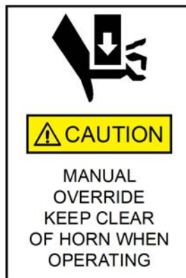
그림 1.3 2000Xc 액츄에이터 후면에 표시된 안전 라벨
