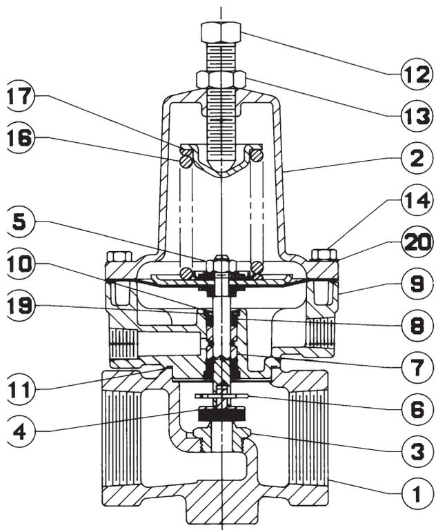
Σχήμα 1. Βαλβίδα ελέγχου Τύπου 119
