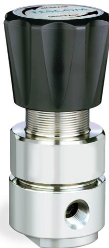
TESCOM 44-2200シリーズは、流量が5 SCFM / 141 SLPM未満の特殊ガス、可燃ガス、工業用ガス流体向けのコンパクトかつ軽量型の高純度シングルステージレギュレーターです。拡散抵抗メタルダイヤフラムシーリングなので、ガス純度と完全性を保証できます。
