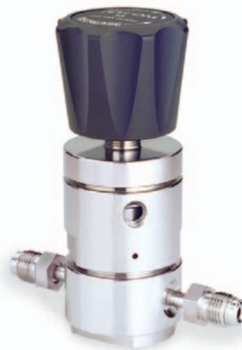
Die Reinstgas-Druckminderer für Absolut-/ Unterdrücke der TESCOM-Serie 64-5000 besitzen eine Oberflächengüte von  $R_a$  0,25  $\mu$ m. Für Eingangsdrücke von 8,3; 41,4 oder 241 bar und Ausgangsdruck-Regelbereiche von 67 mbar absolut - 1,0 bis 6,9 bar.
