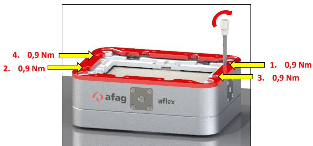
Abbildung 7: Anziehen der Flex-Buchsen
