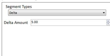
Der Delta-Befehl kann zusammen mit dem *Loop*-Befehl verwendet werden, um den Sollwert über mehrere kleinere Sollwertstufen auf einen Zielwert zu bringen.
