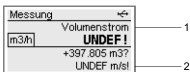
Abb. 13.1: Strömungsgeschwindigkeit außerhalb des Gültigkeitsbereichs
