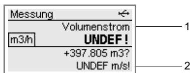
Abb. 13.1: Strömungsgeschwindigkeit außerhalb des Gültigkeitsbereichs
