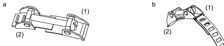
Abb. 6.50: Temperaturfühler am Rohr
