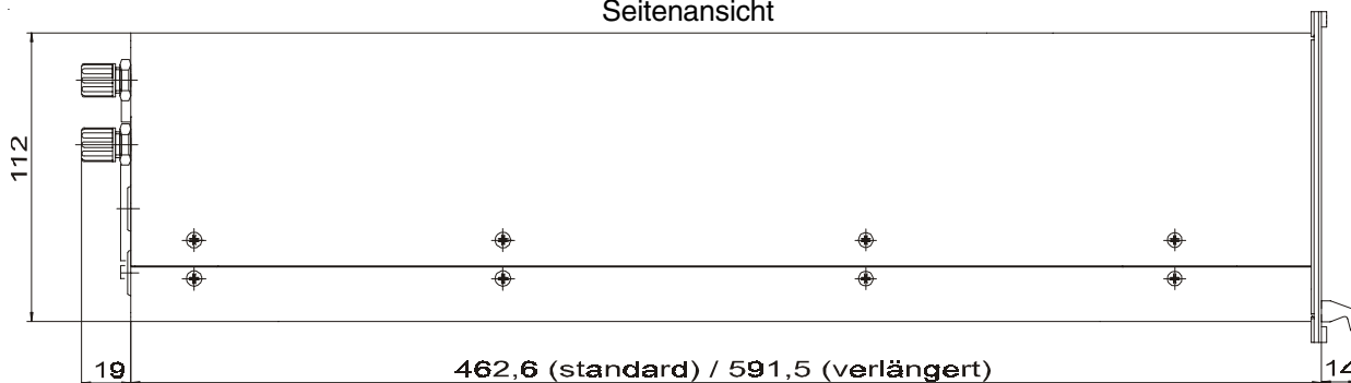
Bild 20-1: Maßskizze MLT 1 [alle Angaben in mm]
