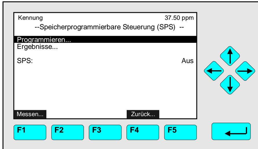
In dem Menü „Speicherprogrammierbare Steuerung“ kann ausgewählt werden, ob eine Steuerung des MLT/TFID-Analysators, -Analysenmoduls oder digitaler Ausgänge über ein vorher gespeichertes Programm erfolgen soll. So kann z.B. festgelegt werden, auf welchen Analysatorausgang bestimmte Kalibrierergebnisse gelegt werden sollen. Die Programmierung und der Schaltzustand der SPS-Ausgänge erfolgen in Untermenüs, die über die Menüzellen „Programmieren...“ bzw. „Ergebnisse...“ erreicht werden können.
