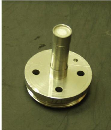
A volte, turbamenti di processo possono causare condizioni sottostechiometriche o di riduzione del processo di combustione. I valori dell'ossigeno da una sonda o più sonde possono ridursi fino a zero. La cella stechiometrica misura la quantità di ossigeno mancante in queste condizioni di riduzione. Le tendenze del DCS possono essere impostate per un limite inferiore del campo di lavoro di -1 o -2% di ossigeno per indicare il livello di carenza di ossigeno.
