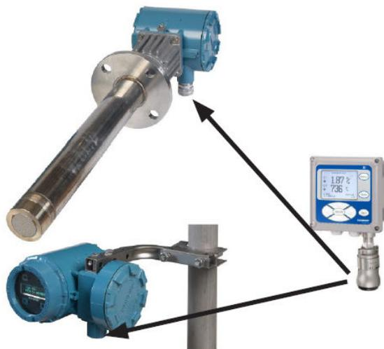
L'adattatore THUM Smart Wireless converte il segnale standard 4-20 mA proveniente dall'Oxymitter o dall'elettronica Xi in un segnale wireless. Tutte le informazioni HART® vengono trasmesse in aggiunta al valore di O<sub>2</sub> di processo. Solo per area sicura.
