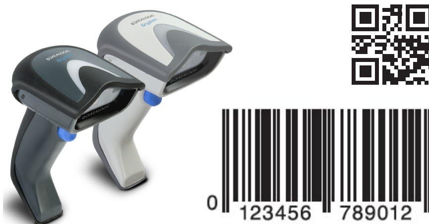
Figur E.6 Strekkodelæser, 1D lineær strekkode & 2D strekkode eksempel
