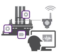
Беспроводной анализатор вибрации CSI 9420 позволяет обслуживать отдаленные и опасные участки при минимальных затратах на монтаж.
