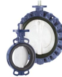
주류 작업 내 광범위한 목적에 적용이 가능한 탄력적이며 검증된 밸브입니다. 본체에 위치한 구멍은 설치와 플랜지 사이의 중심 배치를 용이하게 하고, 둥글게 다듬어진 디스크 엣지는 동심원 밀봉, 낮은 회전력, 더 긴 시트 주기 및 완벽한 차단이 가능합니다. 플랜지 가스켓이 필요 없습니다. 시트를 교체하는 동안 액추에이터를 제거할 필요가 없으며, 버터플라이 밸브는 주류 업계에도 사용될 수 있습니다.
