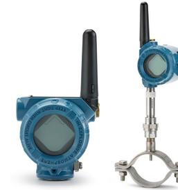
안정적인 모니터링을 제공하는 완전 무선 온도 트랜스미터입니다. 이 트랜스미터는 Rosemount X-well™ 기술과 Rosemount 0085 Pipe Clamp 센서와 결합될 경우 인-트랜스미터 단열 전도 알고리즘을 통해 공정의 온도를 정확히 측정할 수 있으며, 써모웰이나 공정 침투의 필요성을 제거하여 설치 시간 및 비용을 현저히 줄입니다.
