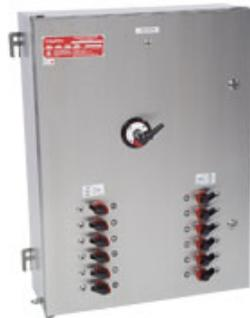
**Appleton PlexPower**는 방폭 경로 보호를 인클로저로부터 개별 서킷 브레이커 하우징으로 이동시켜 전통적인 패널보드 디자인에서 탈피했습니다. 하우징은 표준 선반분리형 브레이커를 위한 폭발 방지 기능을 제공하며, 고가의 특수 브레이커나 무거운 캐스트, 볼트로 연결된 인클로저를 필요로 하지 않아 더욱 간단하고 신속한 유지보수가 가능합니다. 가벼우며, 소형의 재료, 더 적은 롱 케이블 런과 모듈형 디자인 구조는 미리 투입되는 설치 시간 및 비용을 줄여줍니다.
