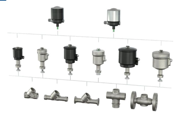
La modularité de la série ASCO 290 permet d'interchanger des actionneurs de tailles et de matériaux différents sur un même corps de vanne. Il est ainsi possible de modifier rapidement et facilement les caractéristiques de la vanne après son montage sur site. Il s'agit d'un atout particulièrement utile pour les installations sur blocs de raccordement. La large gamme d'actionneurs, de corps et de types de boîtiers de commande de toutes tailles permet une multitude de combinaisons.
