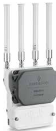
Cisco製WiFiアクセスポイントにドッキングしたワイヤレスゲートウェイ
