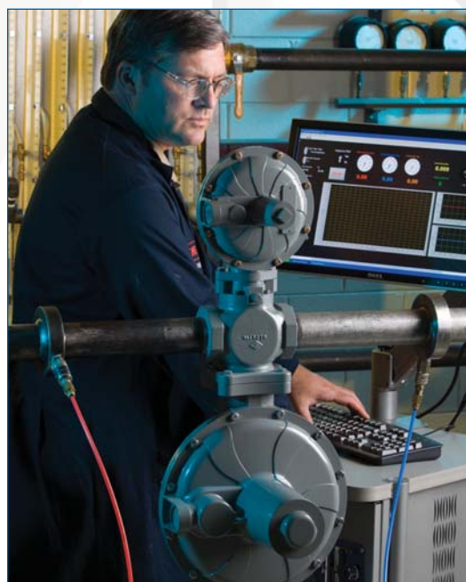
Test de la série CS800 avec protection True-Monitor™ dans les laboratoires d'essais dynamiques d'Emerson à McKinney, Texas.
